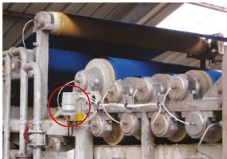
Potravinářský průmysl: mazání kuličkových ložisek lisu.
