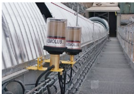
Dobývání nerostů: mazání ložisek dopravníkového pásu.
