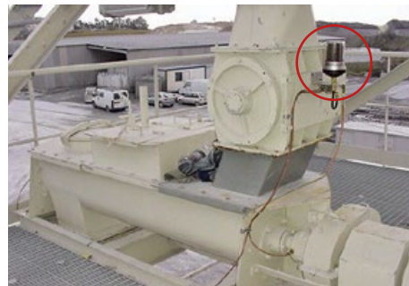
Dobývání nerostů: vápenka: mazání 4 ložisek šroubového dmychadla.
