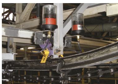
Automobilový průmysl: mazání válečků dopravníkového pásu a kolejnic.
