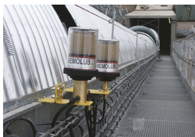
Dobývání nerostů: mazání ložisek dopravníkového pásu.
