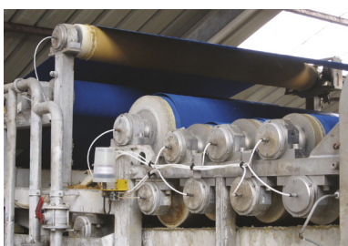
Potravinářský průmysl: mazání kuličkových ložisek lisu.
