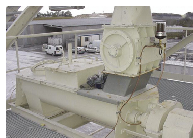
Dobývání nerostů: vápenka: mazání 4 ložisek šroubového dmychadla.
